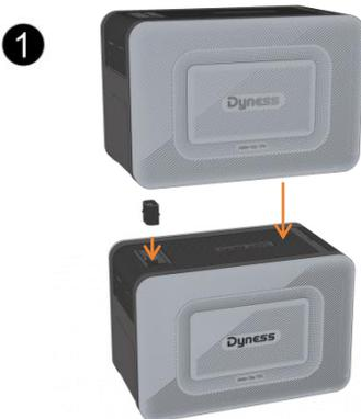
Installieren Sie den Stapelstecker am Batterieerweiterungsanschluss auf der Oberseite des unteren Moduls.
