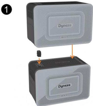
Installieren Sie den Stapelstecker am Anschluss für die Batterieerweiterung auf der Oberseite des Bodenmoduls.
