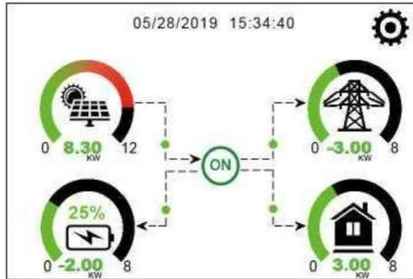
1. Das Symbol in der Mitte des Startbildschirms zeigt an, dass sich das System im Normalbetrieb befindet. Wenn es sich in „comm./F01~F64“ ändert, bedeutet dies, dass der Wechselrichter Kommunikationsfehler oder andere Fehler hat, die Fehlermeldung wird unter diesem Symbol angezeigt (F01-F64-Fehler, detaillierte Fehlerinformationen können im Systemalarmmenü eingesehen werden).
